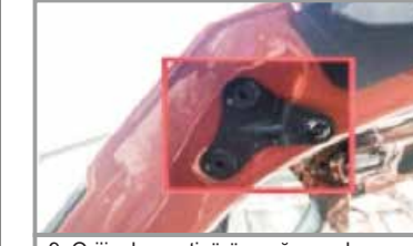
9. Orijinal amortisörün sağ ve sol ayaklarını çıkarın (original vidaları saklayınız).
