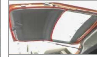
2. Resimde gösterildiği gibi bagaj Kapağının plastiğini çıkarınız
