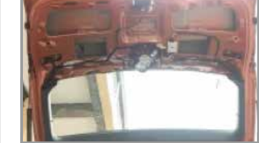
3. Bagaj kapağının plastiğini Çıkardıktan sonraki görüntü.
