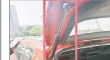
6. Aracın original amortisörlerini çıkarın (öncelikle bir tarafı çıkarmanız önerilir)
